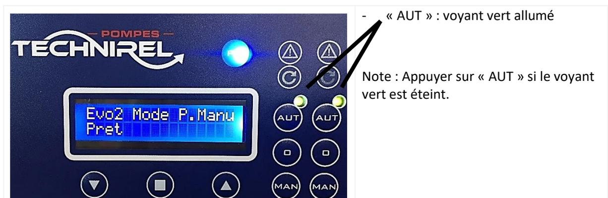
3. Vérifications : mettre en charge la station et vérifier le fonctionnement de la/des pompe(s)
