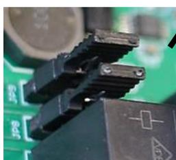
Réglage sortie contact sec : Max 2A
